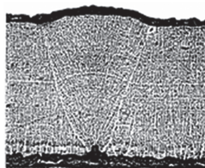
写真2 非伝導粒子または粗い下地の仕上げによる銅メッキの結晶構造の崩れ
