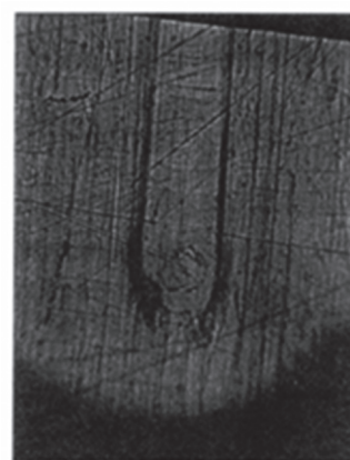
写真2 非伝導粒子または粗い下地の仕上げによる銅メッキの結晶構造の崩れ
